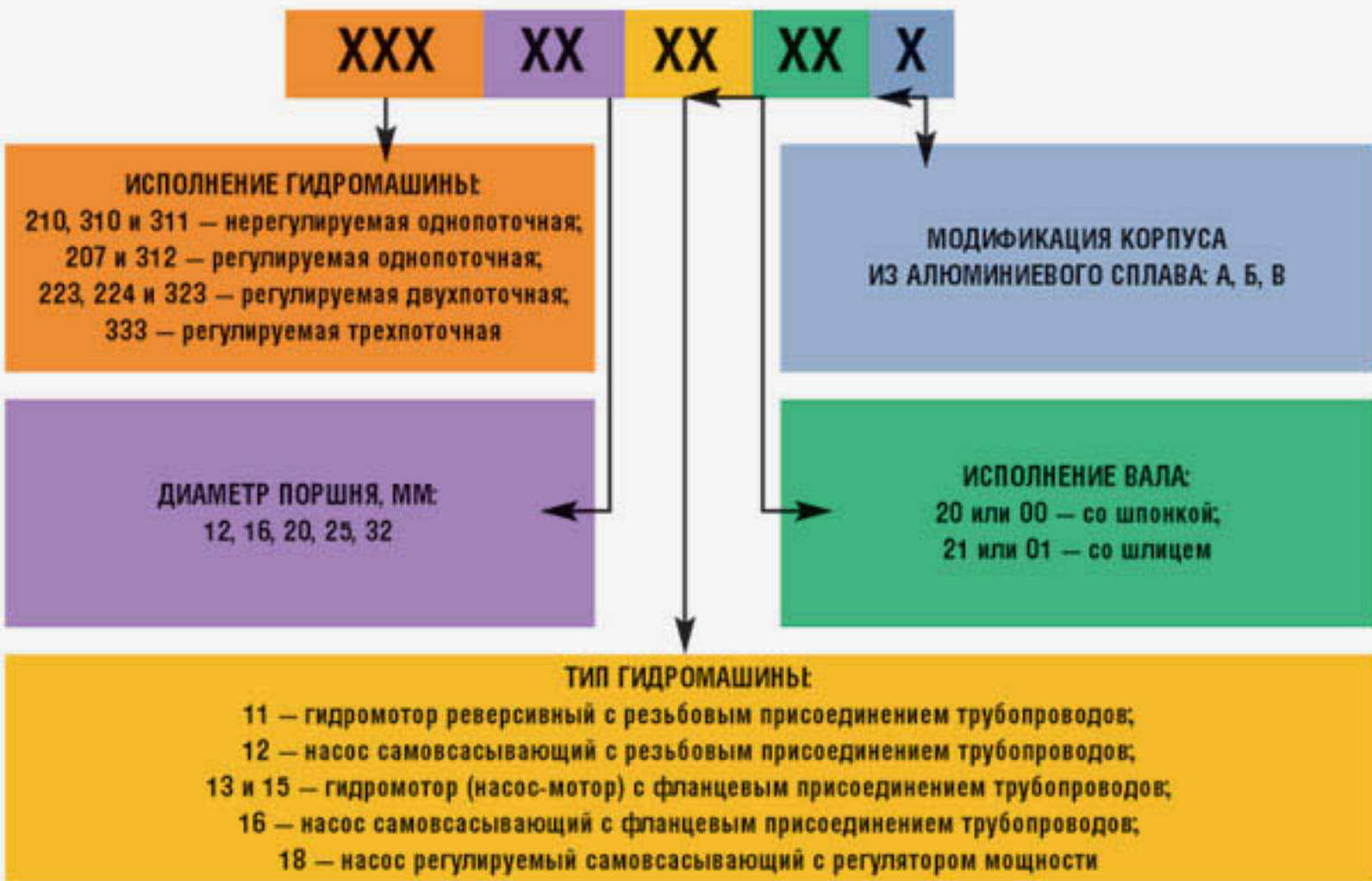
Рис. 2. Расшифровка обозначений аксиально-поршневых гидромашин серий 200 и 300
